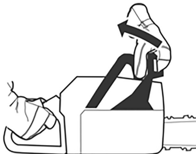
Fig. 31 — Destrabando el freno de la cadena
