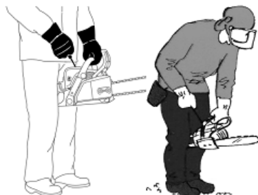
Fig. 29 – Encendiendo la motosierra entre rodillas
