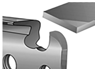
Fig. 42 – Arredondar salto de corte
