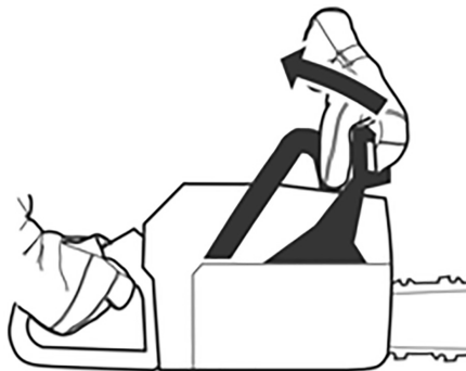
Fig. 34 – Desbloqueando la cadena
