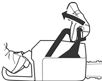
Fig. 34 – Destravando a corrente
