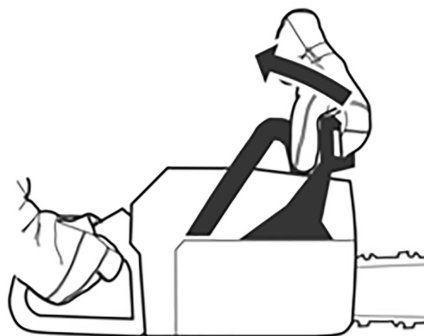
Fig. 31 – Destravando o freio da corrente
