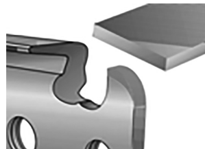
Fig. 42 - Arredondear salto de corte
