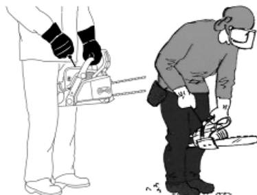
Fig. 29 – Ligando a motosserra entre joelhos
