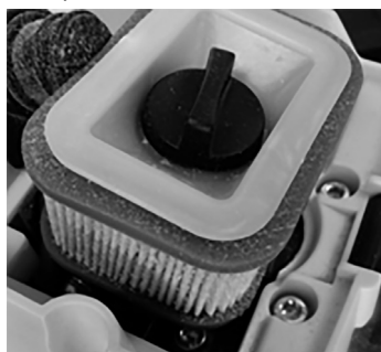
Fig. 43 — Desatornillar la fijación
